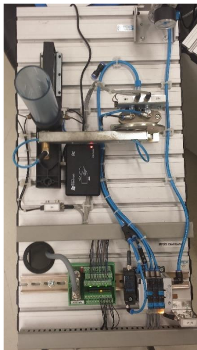
Figura 71 - Leitor RFID na bancada Distributing
